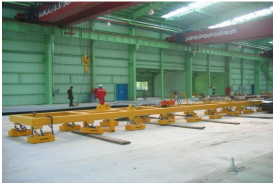
각형 전자석 리프팅 마그네트 Rectangular Electromagnetic Lifting Magnet
