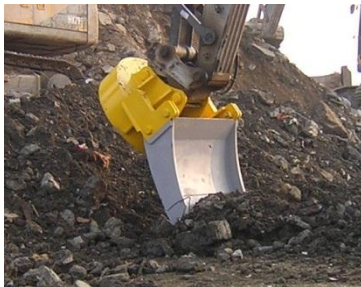
복합형 스크랩 마그네트 Hybrid Scrap Magnet for Excavator
