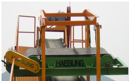
영구자석식 자동 선별기 Self-cleaning Permanent Magnet Separator
