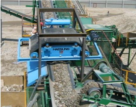
전자식 자동 선별기 Self-cleaning Electro-Magnetic Separator
